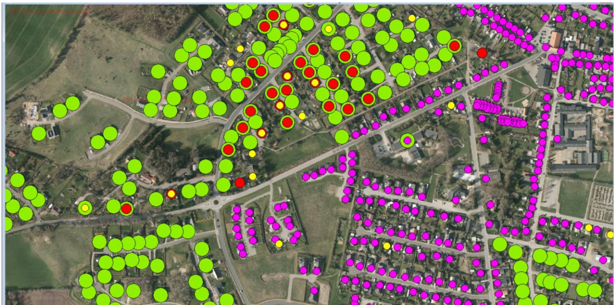
Eksempel 10: Identifikation af olietanke, som ikke er afmeldt i forbindelse med overgang til anden forsyningsart. Eksemplet er fra Viborg.
